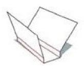
3. Para pastas gruesas o laminadas y productos con grosor de lomo superior a 10mm es necesario formar la caja del lomo perfectamente antes de colocarlos en la maquina, usando preferentemente para este propósito una mesa de pecado con doble marcador.
